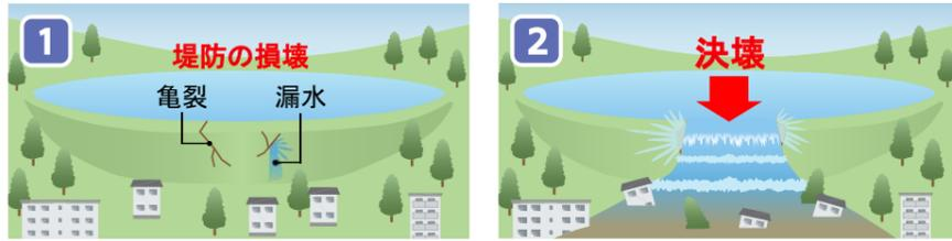
大きな地震、大雨等で堤防が損壊(亀裂や漏水)や破損した堤防が貯水に耐え切れず「決壊」堤防前面の滑落箇所から漏水など
