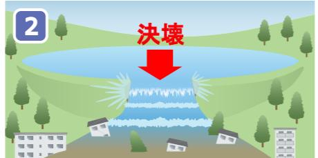
大きな地震、大雨等で堤防が損壊(亀裂や堤防前面の滑落箇所から漏水など)
